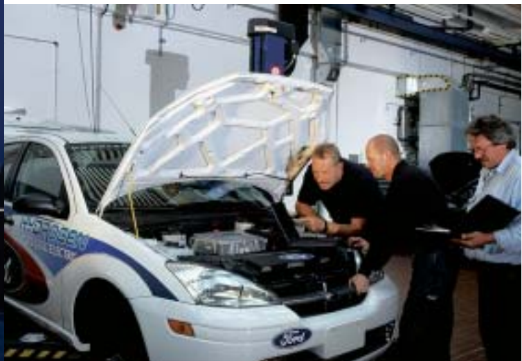
Der Antrieb von morgen: FFA-Forschungsingenieure mit der Ford Focus Brennstoffzelle Hybrid, die aus Wasserstoff Geschwindigkeit erzeugt
